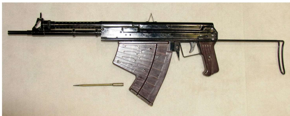
Billedet viser en APS riffel med en tilhørende patron. Bemærk projektilens længde i forhold til en normal patron. Læg også mærke til den sammenklappelige kolbe og det usædvanlige magasin samt de små huller, som ses i gasmekanismen placeret over geværets løb. Uden for aftrækkerbeskytteren ses magasinudløseren. Kilde: Remigiusz Wilk.
