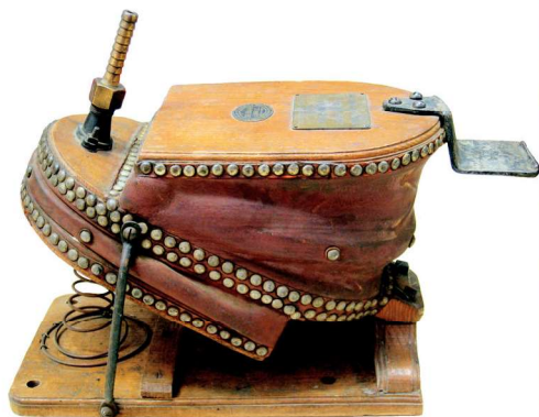
Siebe Gorman blæsebælg til brug for røgdykker. Apparatet har to bælg, hvor den ene fungerer som kompensator for udligning af trykstød i luften.
