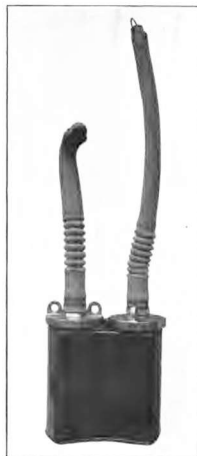
Hall Rees apparatet var blandt de apparater, som George Stillson testede i 1915 (se DHT nr. 60). Illustrationerne her er fra US Navy's "Report on Deep Diving Tests" og viser Oxylythe beholderne samlede og adskilte.
