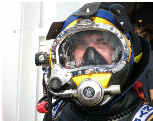
Øverst: Operatør og to deltagere i TUP klokken. Lugen i bunden er blevet åbnet, og det grønne lys fra vandet ses. Midte: TUP klokken th. er koblet til dekokammeret og begge tryksat for overførelse af mandskab. Nederst: NYD dykker med Kirby Morgan Band Mask.
