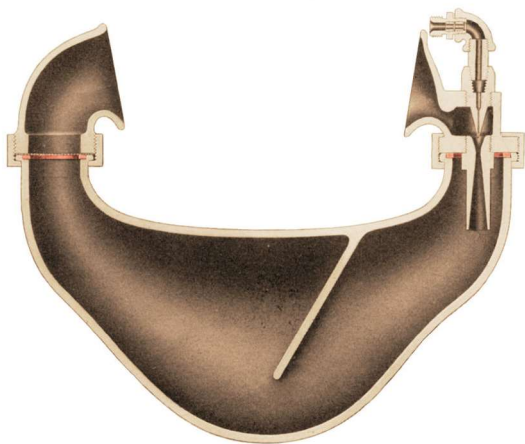
I højre side af denne gennemskårne kalkbeholder ses injektoren og i midten ses skillepladen, der skal sikre mod luftkanaler i kalken. (US Navy Diving Manual 1943)
