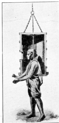
Guglielmo de Lorenas dykkerklokke med hvilken der i 1535 blev dykket ved kejser Caligulas lystgalejer, der var sunket i Nemi søen i Italien
