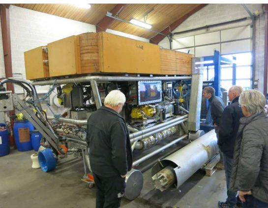
ROV beregnet til nedspuling af kabler
