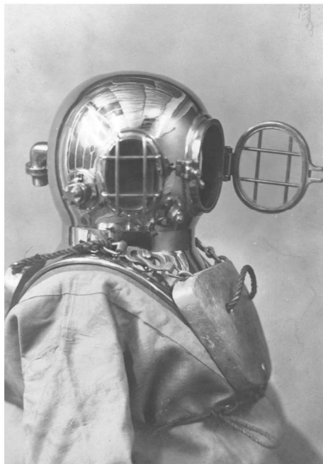
Hjelmen fra Franz Clouth brochuren. Bemærk lufttilgangsventilen der er af samme design som på den ombyggede hjelm, og at luftafgangsventilens håndhjul ikke er gennemboret for akslen
