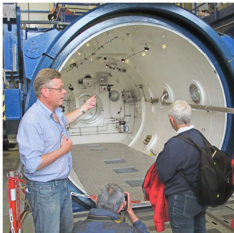
Kåre Segadal orienterede om NUI's kammeranlæg. Her det det kammeret, der kan trykkes op til 150 m dybde. Foto: Japp Stenger
