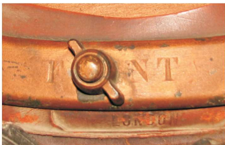
Den nederste bolt på brystpladen synes at være eftermonteret, da mærket "front" er blevet gennemboret.
