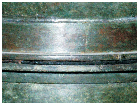
Ø'erne i over- og underflangen skal stå over hinanden, når hjelmen er korrekt drejet i forhold til brystpladen.
