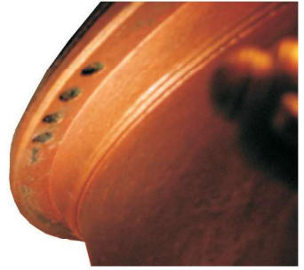
I underflangen er der boret ikke mindre end 4 huller for låsebolten
