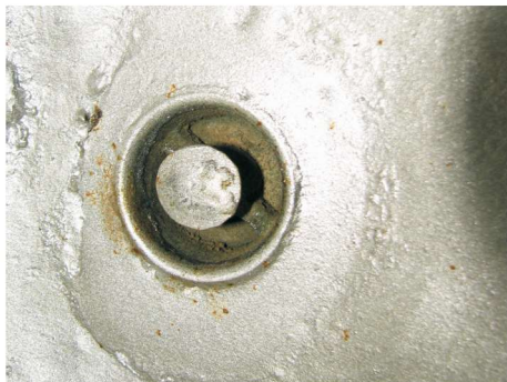
Hjelmen er blevet repareret ved lufttilgangen. Ved siden af lufttilgangen se luftafgangsventilen, som indvendigt er forsynet med en nikkeplade, der giver dykkeren mulighed for at åbne ventilen med hovedet.
