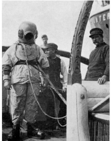
Billede af dykker om bord på Svitzers skib Hertha i 1895. Hjelmen er en Sadler hjelm med sidehængt frontvindue og boltesamling til dragten
