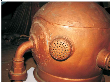
Hjelmen er blevet repareret ved lufttilgangen. Ved siden af lufttilgangen se luftafgangsventilen, som indvendigt er forsynet med en nikkeplade, der giver dykkeren mulighed for at åbne ventilen med hovedet.
