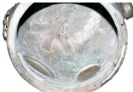
Luftkanalerne øverst i hjelmen leder den indpumpede luft mod vinduerne for at holde disse dugfri.
