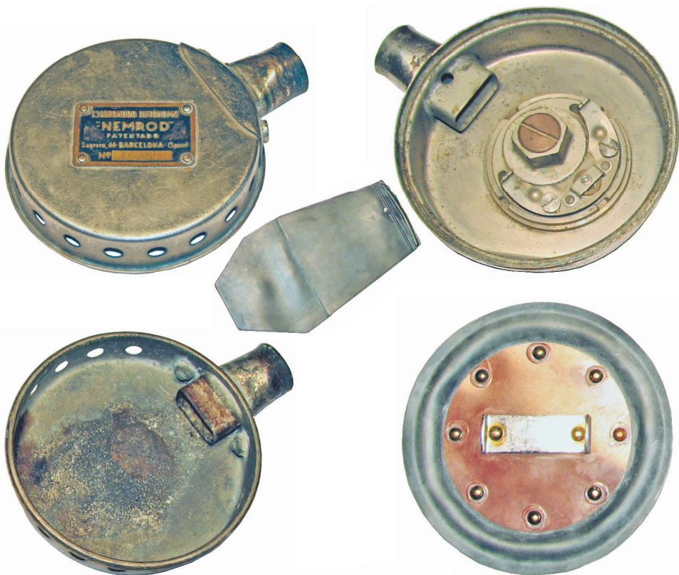
Figur 4. Nemrod lungeautomat model CG45 (Erik Østergaards automat). Andenæbsventilen og membranen er originale La Spirotechnique CG45 reservedele fra forfatterens egen samling, og kan således ikke dokumenteres som værende identiske med de gummidele, automaten oprindeligt blev leveret med. Et særligt kendetegn for denne automat, er designet på justerings-skruen for justering af mellemtrykket. Justerings-skruen er udført uden gennemboring, og derved forhindres lufttilgang fra automaten til oversiden af 1. trinnets membran. Automaten er indkøbt som ny i U.S.A. i 1950'erne og umiddelbart derefter givet som gave til Erik Østergaard. Lungeautomaten er udlånt til Dykkehistorisk selskab af Erik Østergaard.
