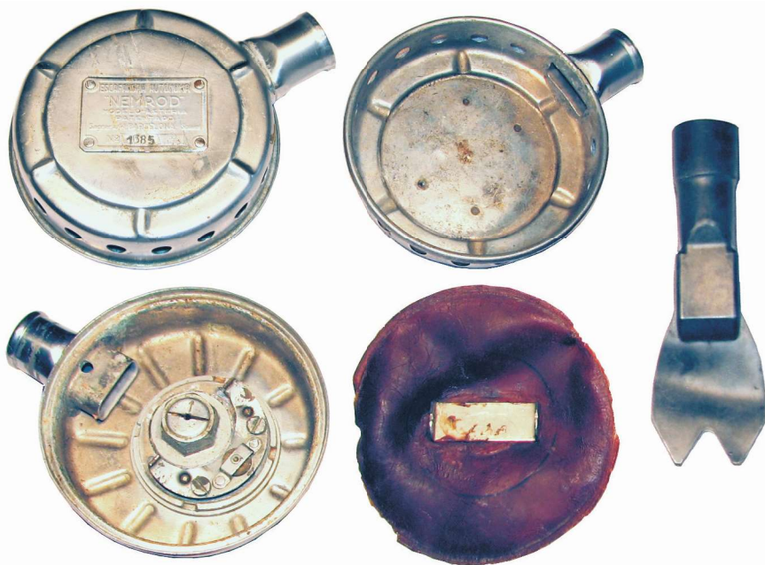
Figur 8. Nemrod lungeautomat model Asteria. Membranen er den originale Nemrod membran og adskiller sig fra andre membraner, tilvirket til lungeautomater fremstillet med udgangspunkt i CG45 designet, ved, at membranens metaldel har meget lille anlægsflade imod gummimembranen. Endvidere er der i metaldelen to spor, hvori enderne på 2.trinnets hesteskoarm fikses. Den her viste andenæbsventil er ikke en Nemrod andenæbsventil, men er derimod en andenæbsventil designet til en La Spirotechnique Mistral lungeautomat. Det er ikke lykkedes at fremskaffe vidnesbyrd om, hvorledes den originale Nemrod andenæbsventil har set ud. Begge horn er loddet på automathuset og hornenes ender er bertlede. Automaten er fremstillet med en justeringsskrue for justering af mellemtrykket og udført med gennemboring, der muliggør lufttilgang fra automaten til oversiden af 1. trinnets membran i overensstemmelse med patentet til forbedring af lungeautomat model CG45, der blev udtaget af Don Juan og Don Pedro Vilarrubis Ferrando i 1954. "Asteria" kommer fra den græske mytologi, hvor hun er datter af Titanerne Krios og Foibi - Asteria levede på Olympen og var efterstræbt af Zeus, som hun slap fri fra ved i skikkelse af en vagtel at kaste sig i Ægæerhavet. Doneret af Erik Østergaard.
