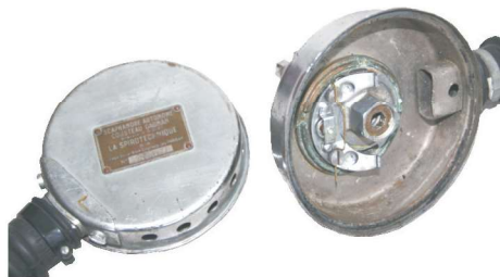
Figur 5. La Spirotechnique CG45 S.A. lungeautomat. Bemærk at fjedertryk på 1. trins membran kan justeres med en justerskrue. Billedet er udlånt af Eric
