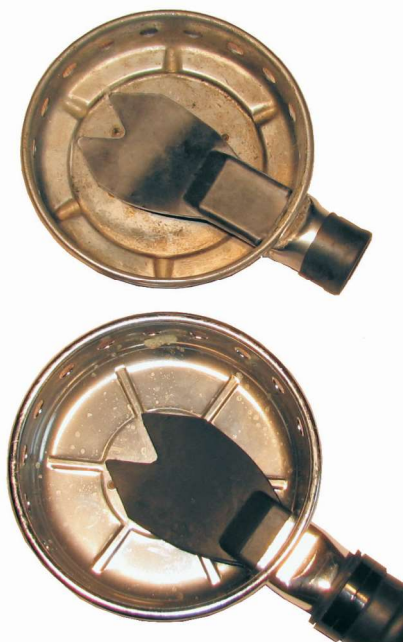
Figur 11. Øverste del af huset til Lungeautomaterne Nemrod Asteria og La Spirotechnique Mistral. Begge er kendetegnet ved følgende fælles kendetegn: Hornet er påloddet huset. På enden af hornet er der en bertlet kant for bedre fastholdelse af slangen, andenæbsventilen fastgøres ved, at den omkraves og limes fast inden slangen påspændes automaten. Begge automater er dekoreret med seks "solstråler" strålende ud fra centrum.
