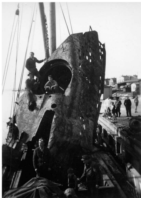
På den agterste del af tårnet fra type XXI ubåden ses montage for 20 mm maskinkanon og skjul for snorkelapparatet
