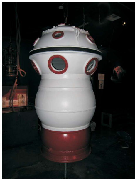
Galeazzi's patenterede observationskammer med roterende stol. Øverst illustration fra patentet og nederst observationskammeret. (History og diving Museum i Florida)
