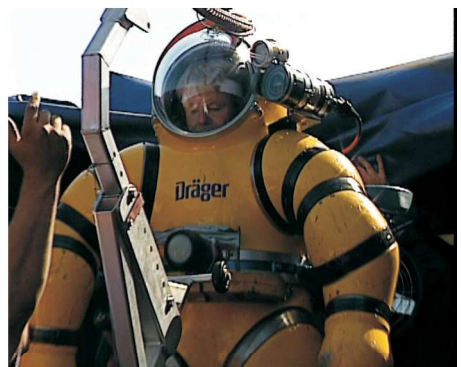
I forbindelse med bjergningen af U534 ved Anholt i 1993 blev der anvendt en Newtsuit
