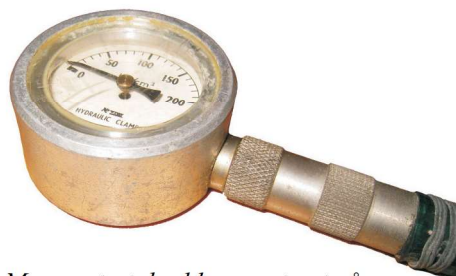
Manometret der blev monteret på en forskruning på automaten.
