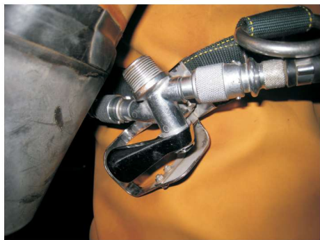
Med reserveluftomskifteren i dykkerens bælte kan overfladeforsyningen, som er koblet til gevindelen på ventil, frakobles og luftforsyningen fra den rygmonterede flaskepakkens reduktionsventil indkobles.
