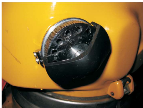
Luftafgangsventilen, er af Zetterström-typen med en membran, der blokerer for vandindtrængning i hjelmen. Ventilen kan åbnes inde fra hjelmen med hovedet og udvendig fra kan ventilen lukkes ved at trykke på den sorte plastbøjle. Justering foregår ved at dreje selve ventilen.
