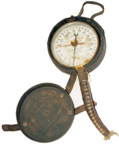
Manometer fra Friederich HC Heyn, Hamburg (Søværnest samling) visende dybde i meter. Tilkobles til nikkepumpe over luftslangefordeler.
