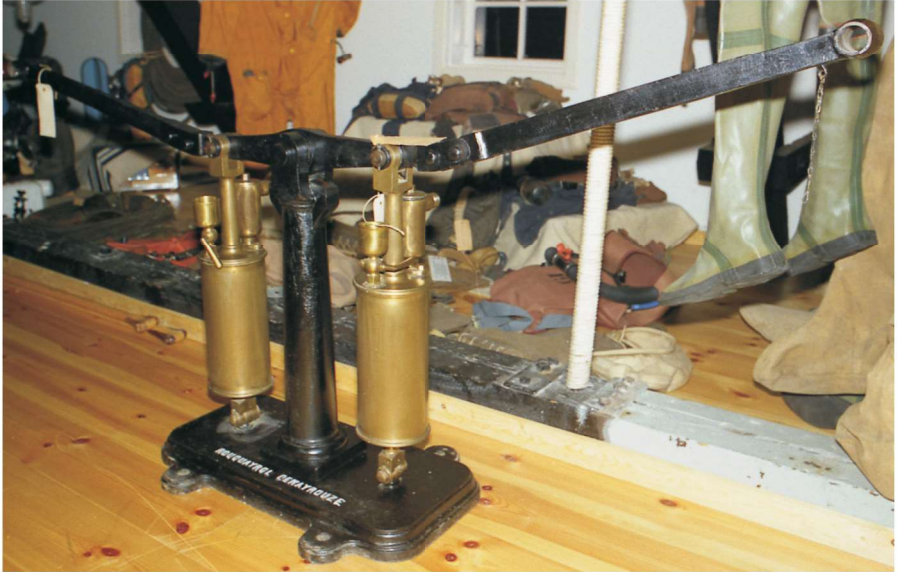
Rouquayrol Denayrouze nikkepumpe (Søværnets samling). Pumpen er måske den pumpe, der blev leveret til Søværnet sammen med Rouquayrol Denayrouze regulatoren.
