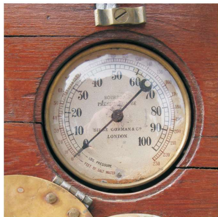
Manometer på Siebe Pumpe visende trykket i pund pr. kvadrattomme (PSI) med sorte tal og dybde i fod med røde tal.
