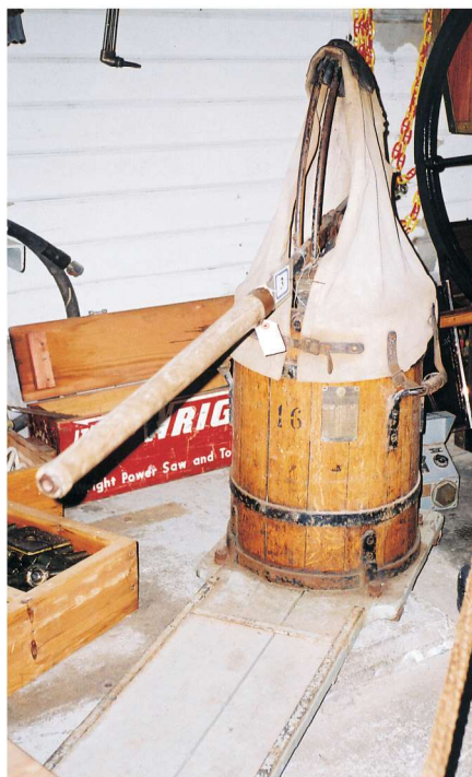
Svensk produceret 1-cylindret nikkepumpe fotograferet i Dyktankhuset i Stockholm. Pumpen er monteret i en tønde, hvor der kan hældes vand for køling af pumpen. Tønde og pumpe er monteret på et brædt, som pumpe- manden står på, for at stabilisere pumpen, når der pumpes.
