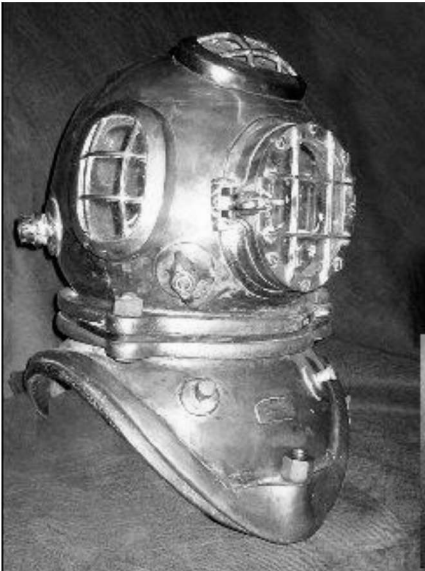
H. Christiansen hjelm suppleret med en 3-bolts samling. Endvidere er sidevinduerne placeret højt, hvilket er typisk for mange af disse hjelme.
