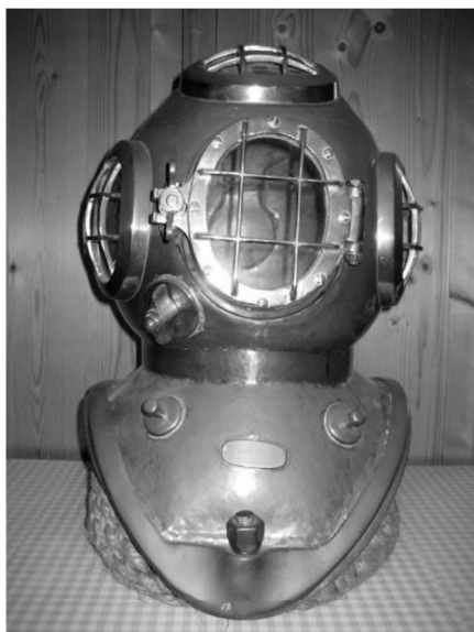
En meget groft forarbejdet H. Christiansen hjelm. Alle afvigende H. Christiansen hjelme har tilsyneladende et støbt frontgitter.
