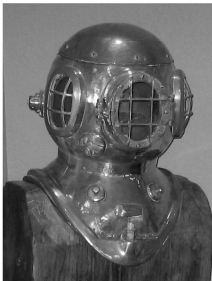
En meget groft forarbejdet H. Christiansen hjelm. Alle afvigende H. Christiansen hjelme har tilsyneladende et støbt frontgitter.
