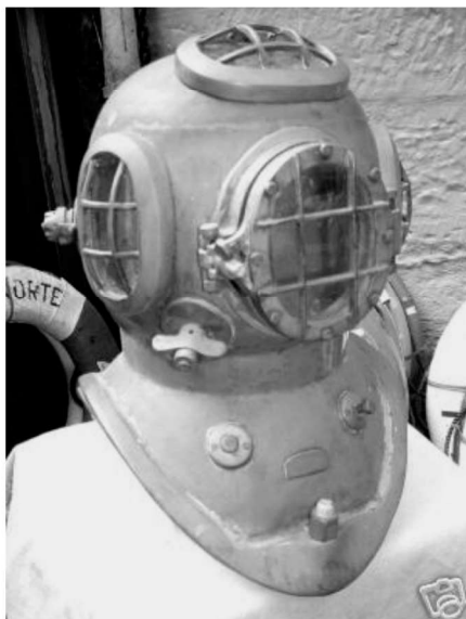
H. Christiansen hjelm hvor frontvinduet Frontring er fastgjort med skruer med 6-kantet hoved, og hvor hjelmkuppens top er lodret lige over vinduerne. Denne hjelm er med mindre afvigelser fra normen
