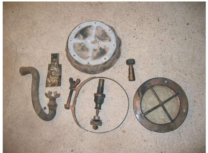
Dele fra zinkkassen fra venstre: bidemundestykke, andenæb, membran, spændering, ventil og endebund til regulatortank
