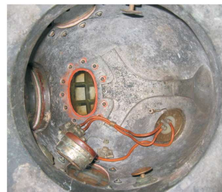
Indvendig i selskabets hjelm ses de fladt afskårne luftlederør, den fast monterede mikrofon og stikket for tilkobling af hovedtelefonerne i hjelmen.
