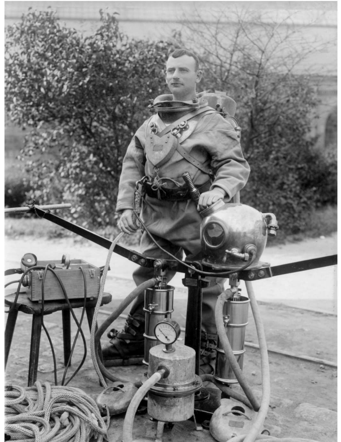
Vort hollandske medlem David Dekker har sendt os en kopi af dette postkort visende en dykker med Frantz Clouth udstyr tilsvarende det, der har været anvendt ombord på Undine. Læg mærke til at hjelmen har 2 lufttilslutninger
