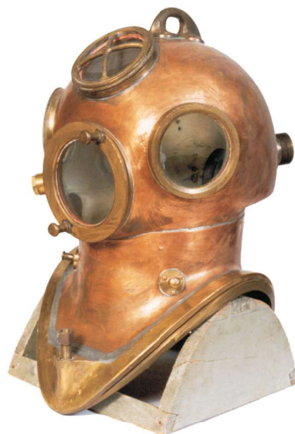
"3-bolts-hjelm" fra Drägerwerk monteret på en 2-bolts brystplade.
