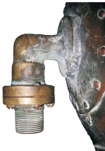
Lufttilgangsventil af den oprindelige type anvendt på 2-bolts-hjelmene
