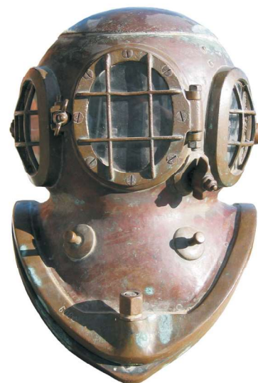
Stærk bygget stenfiskerhjelm specialfremstillet til korthalset dykker af H. Christiansen. Sidevinduer er af Siebe Gorman typen, og frontvinduet er med støbt gitter.
