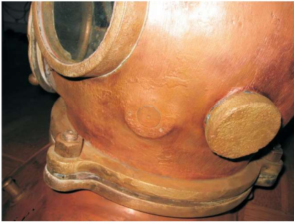
Lukning af hul efter lufttilgang på den anden bjergede hjelm. Dækslet til højre dækket telefonstikket
