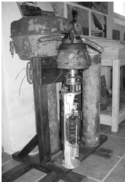
Torpedopistol med akustisk homingsystem fra U534 udstillet på "Gården" ved Grenaa
