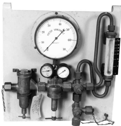
Panel for manuel regulering af luftflow til dykkeren (Søværnets Dykkerskoles samling)
