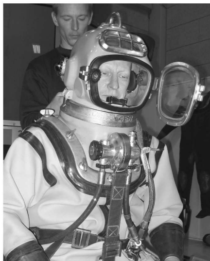
DM220 trugdykkerapparat med dykkeautomat på brystpladen
