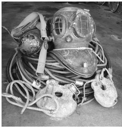
Oles aktive udstyr med bail-out flaske, der er tilsluttet stutsen på venstre side af hjelmen
