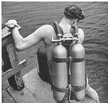
PA 60 automat vist i Dräger-hefte nr. 226 marts 1956. Automaten er indbygget i et hus af samme type som PA51 eller Delphin II og må være en prototype
