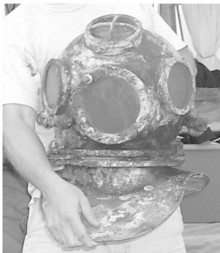
Den først bjærgede hjelm. På hjelmens venstre side ses lufttilgangen
