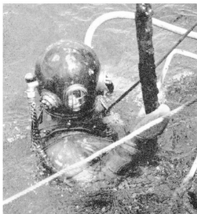
Zetterström luftafgangsventil. Ventilen er med nikkeplade for åbning med hovedet, og har membranplade der blokerer for vand udefra og ind.
