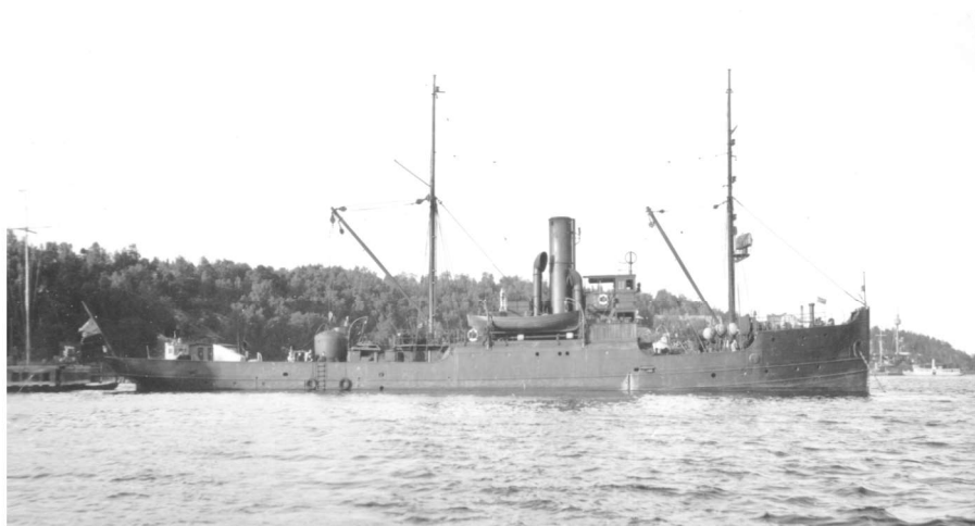
Ubådsrednings- og dykkerskibet Belos som dykningerne foregik fra. Bemærk redningskammeret af "Momsen" typen på agterdækket.
