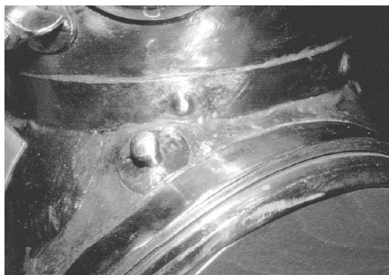
Knaster for montage af lodder er placeret meget højt, og samling mellem brystplade og hjelmkuppel er forstærket med 4 kobbernitter.
