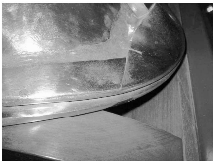
De pånittede messingplader er "ned-fældede" i forstærkningsflangen.
