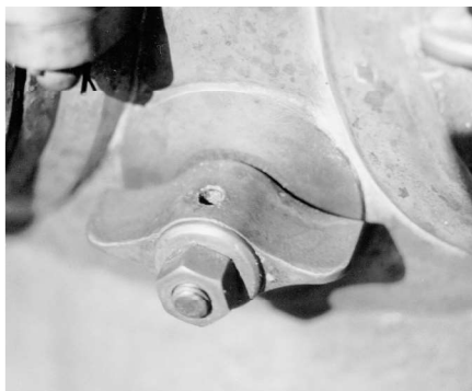
Lufthanen åbner en forbindelse mellem hjelmens indre og havet når den drejes 90 grader
