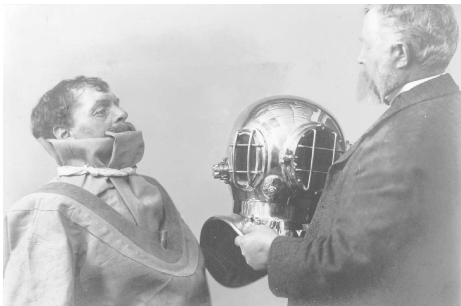
Illustration fra brochure fra Franz Clouth visende hjelmmonteringen. Dragten er snøret højt op om dykkerens hoved for at forhindre, at vand, som står mellem dragt og hjelm, trænger ned i dragten. Det er Peter Hansen, der holder den nypudsede hjelm
