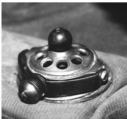
Overtryksventil med bøjle i stilling til opstrigning.
