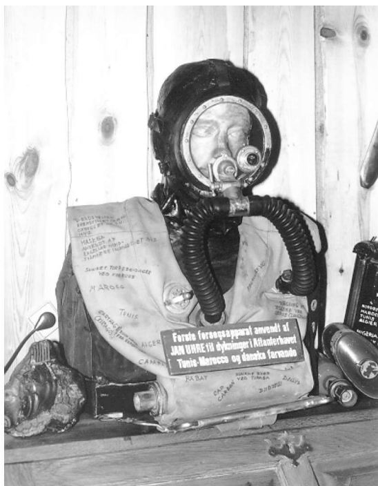
Jan Uhre's Tauchretter modificeret med dobbeltslanger og Siebe Gormann helmaske med eftermonteret telefonstik.
